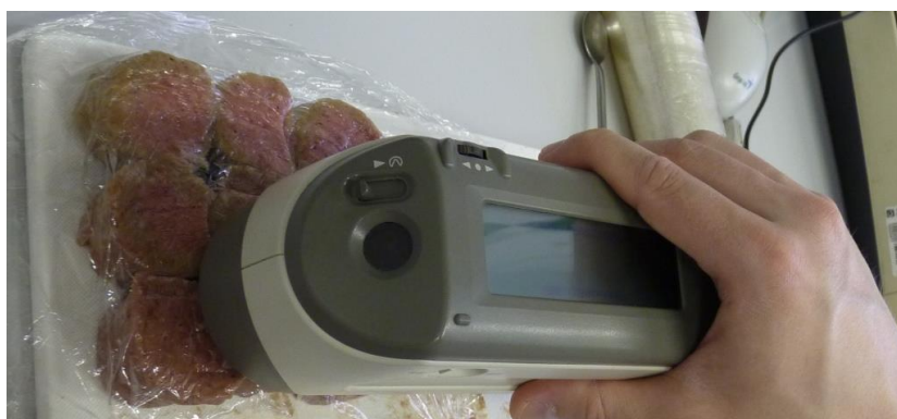
Obrázek 5: Měření barvy pomocí spektrofotometru CM-2600d Minolta Scanning.
