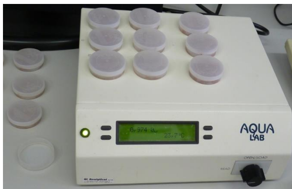
Obrázek 4: Průběh měření aktivity vody na přístroji Aqualab
