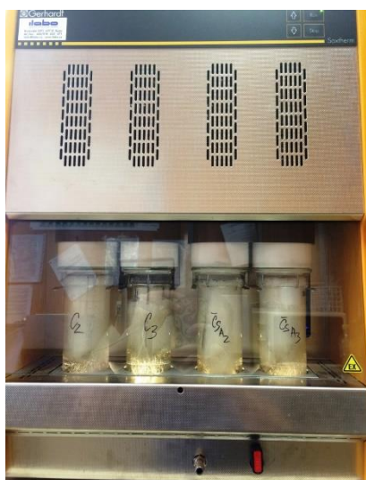
Obrázek 3: Extrakce tuku ze vzorku na extrakčním zařízení Soxtherm SE-414
