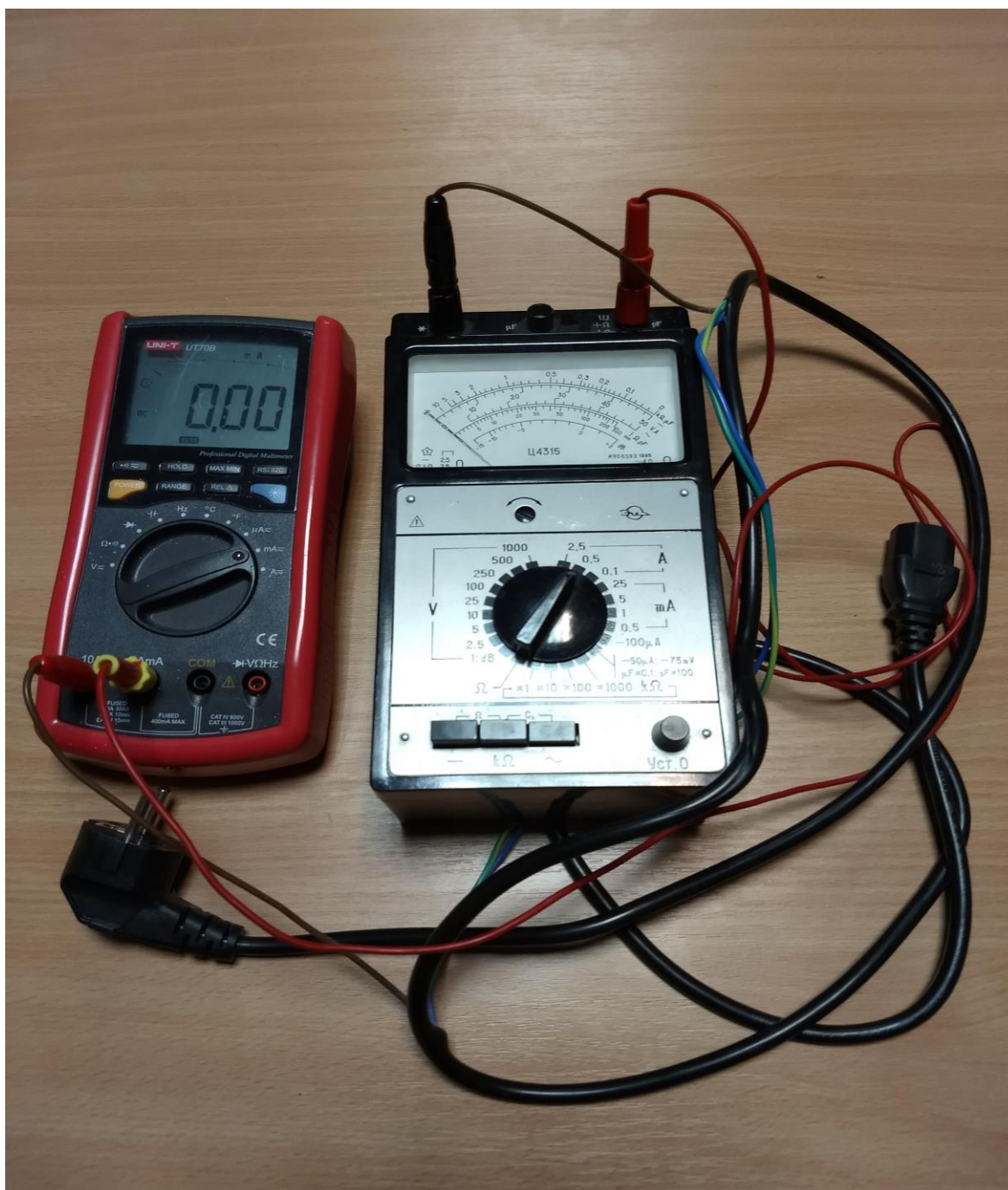
Obrázek č. 5 Měřící zařízení UT70B UNI-T a U4315 od výrobce Apem
