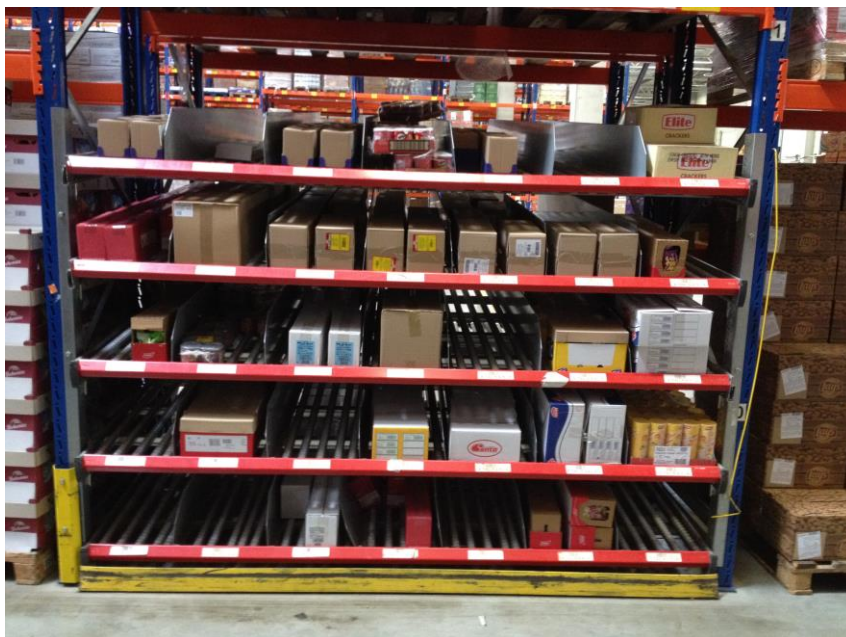
Obr. 18 [logistické centrum Jirny] – Spádový regál
