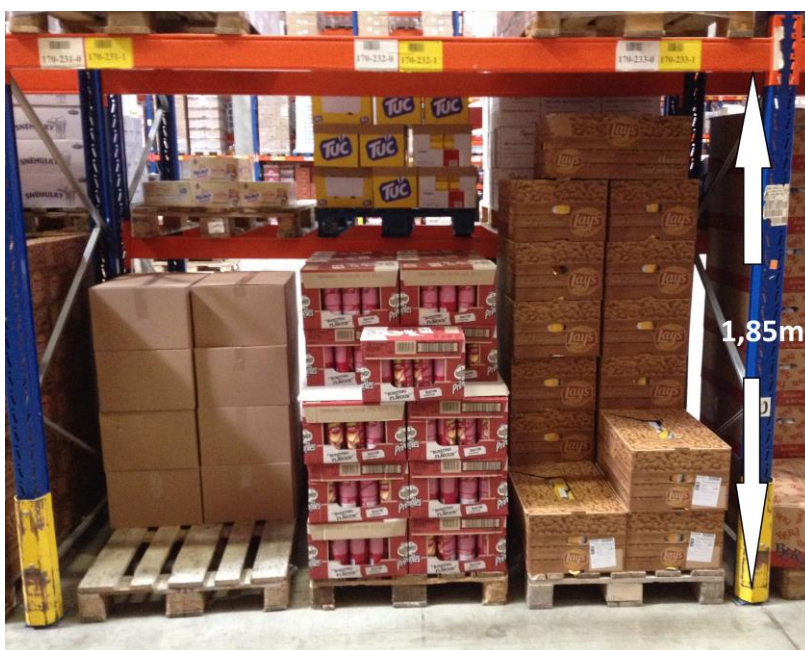
Obr. 17 [logistické centrum Jirny] – Paletový regál, manipulační pozice velikost CCG2 (1,85m)
