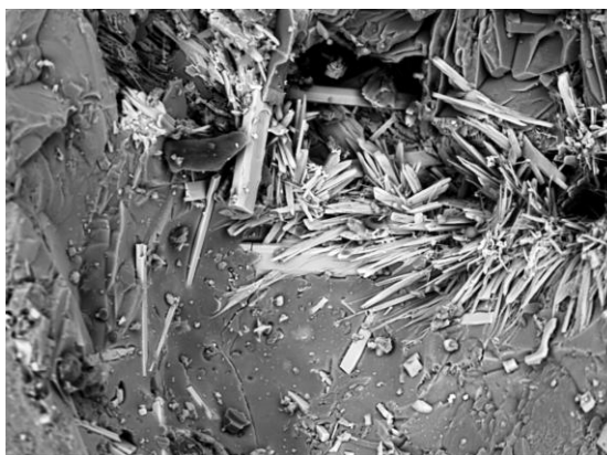
Obr. 4.2: Detail korozní vrstvy – krystaly oxidu sodno-trivanadičného pokrývající povrch dutiny ve vrstvě korozivních produktů.
