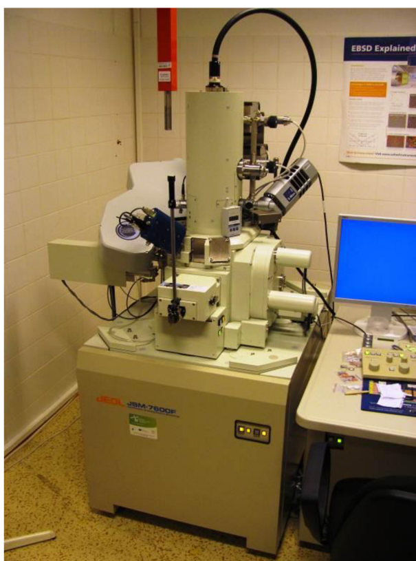
Obr. 3.2: Mikroskop JEOL JSM-7600F.
