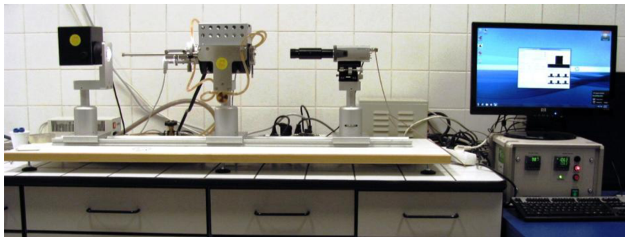
Obr. 3.8: Žárový mikroskop EM201 (Leitz)
