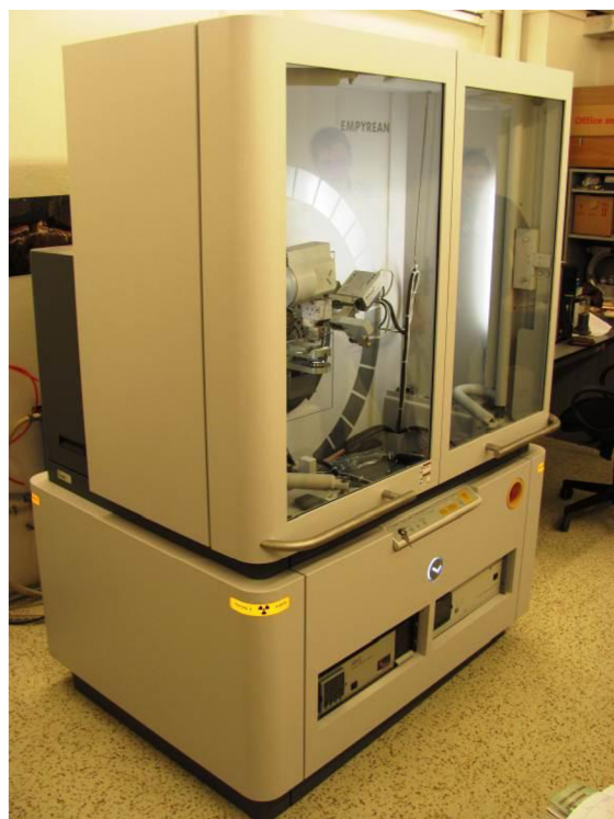
Obr. 3.4: Přístroj X'pertEmpyrean použitý pro stanovení fázové složení vzorků žárovzdorného materiálu (a) a pohled na goniometr se zásobníkem vzorků (b).
