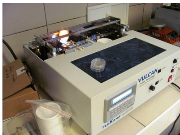
Obr. 3.5: Rentgenová fluorescence (a) a tavící zařízení (b).
