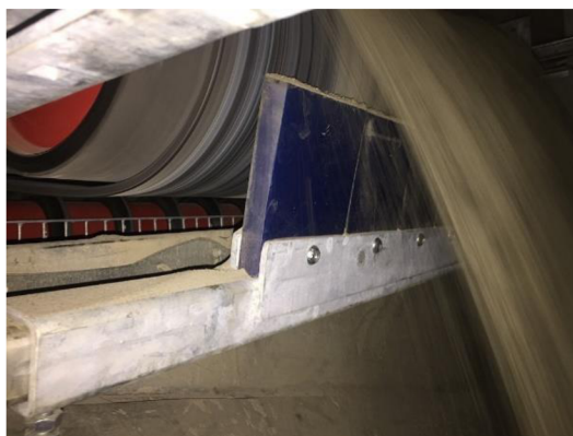
Obr. 25 Čelní stěrač CJ 1.1 + materiál [11].
