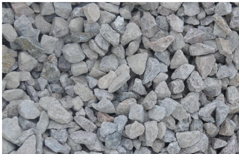
Obr. 2 Štěrk o velikosti frakce 16–32 mm [7].
