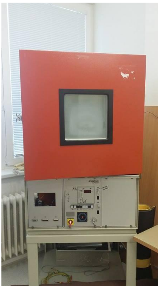
Obrázek 1: Klimatická komora Heraeus VMT 04/140
