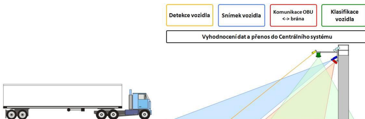
Obrázek 13 - Schéma funkce kontrolní mýtné brány.
