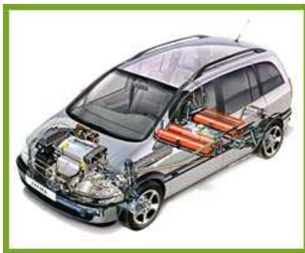
Obr. č. 1. Uložení tlakových nádob ( http://www.cng.cz )
