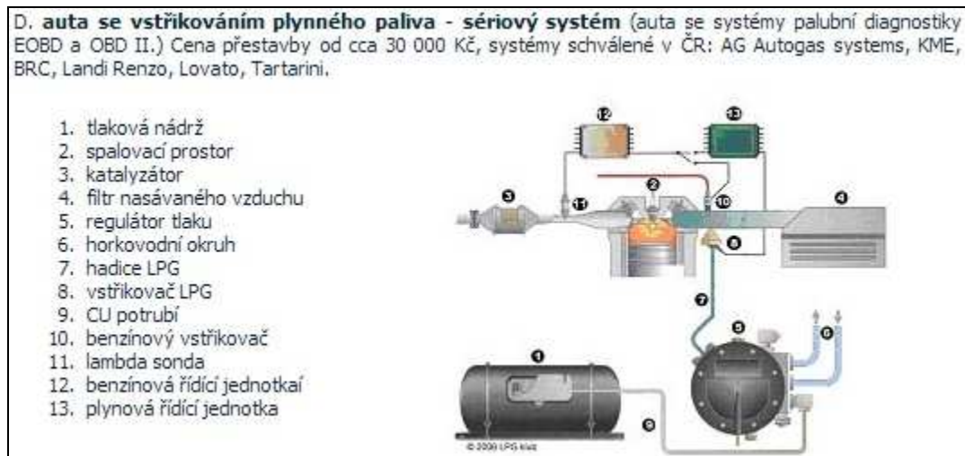
Obr. č. 6. Schéma sériového systému vstřikování plynného paliva ( http://www.lpg.cz/ )
