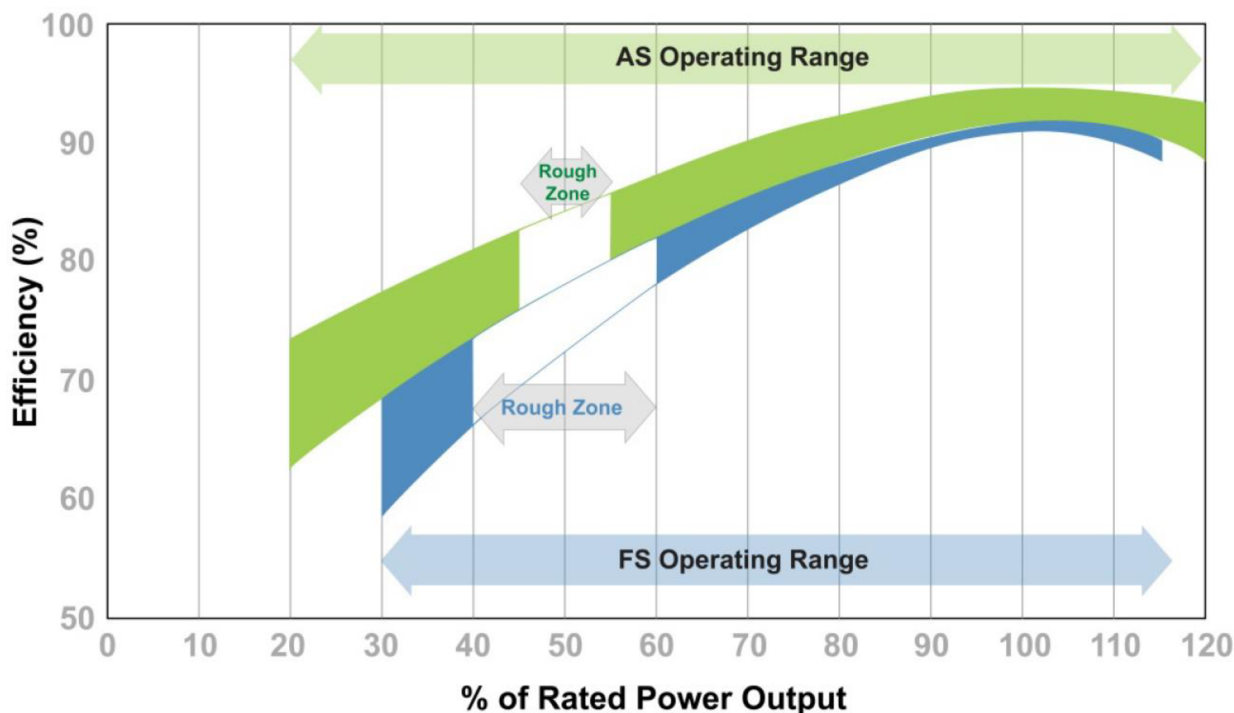
Obr. 12 Účinnost a provozní rozsah v generátorovém/turbínovém režimu [16]
