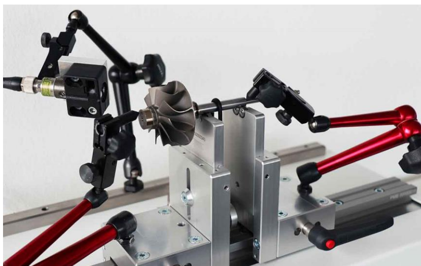
Obr. 8 Rotor na vyvažovacím stroji [19].
