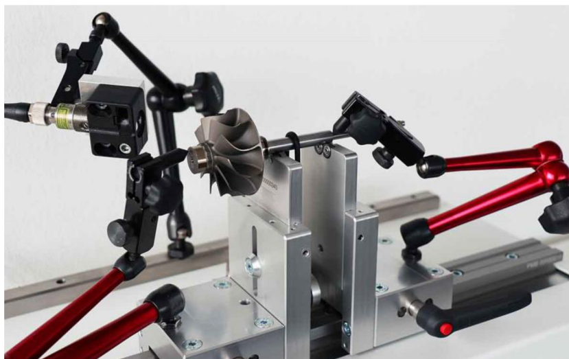
Obr. 8 Rotor na vyvažovacím stroji [19].
