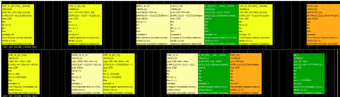
Obr. 18: Činnost komponenty dekodéru instrukcí během obsluhy přerušení, meteorologická stanice
