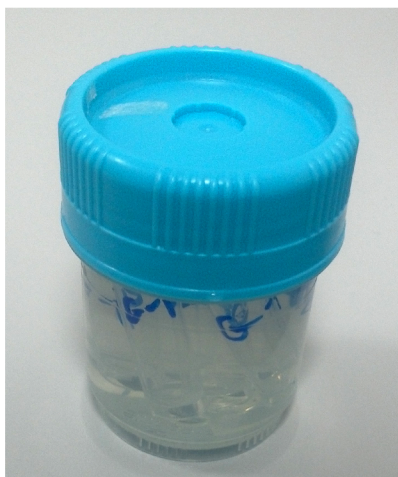
Obr. 3.2: První verze fantomu pro měření relaxačních časů T_1
