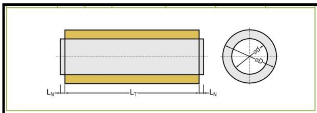
Obrázek 31 - Konstrukční provedení kruhového tlumiče bez jádra[8]
