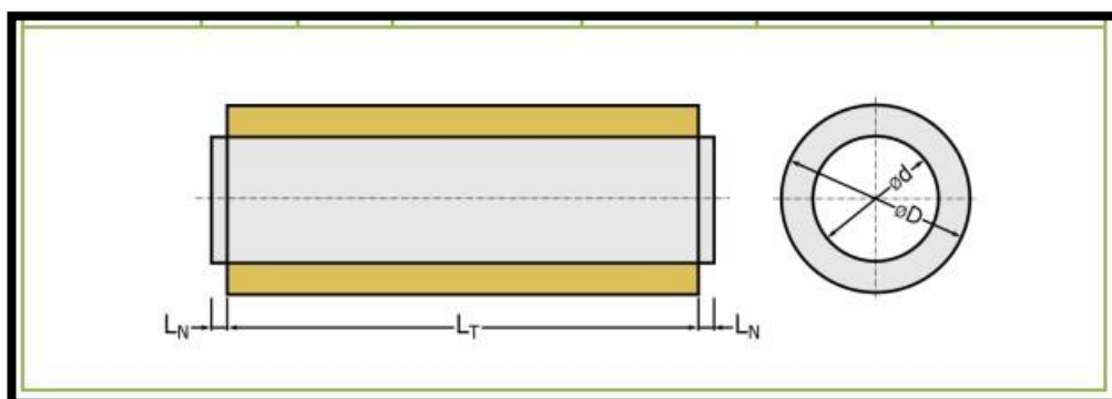
Obrázek 37 - Konstrukční provedení kruhového tlumiče bez jádra[8]
