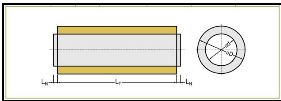
Obrázek 20 - Konstrukční provedení kruhového tlumiče bez jádra[8]
