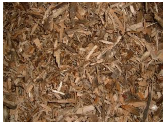
Obrázek 7: Dřevní štěpka vyrobená kladivovým drtičem
