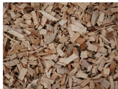
Obrázek 6: Dřevní štěrka vyrobená nožovým štěpkovačem
