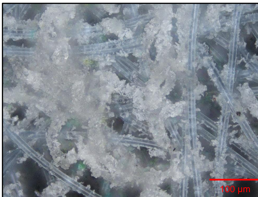
Obr. 32 Snímek třísek po 30 min. obrábění vzorku č. 1 (20 x přiblíženo).
