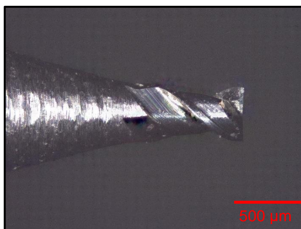
Obr. 19 Snímek řezné části nového nástroje, vyfocen mikroskopem KEYENCE VK-X1100.
