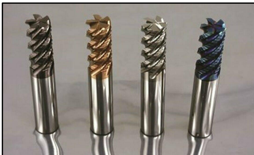
Obr. 4 Povlakované čtyřbřité monolitní frézy s povlaky na bázi AlTiN , TiCN , CrAlSiN , TiAlSiN (zleva doprava). [8]
