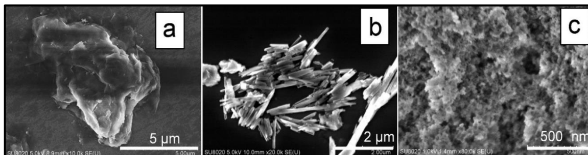
Obr. 5 SEM fotografie jednotlivých druhů výztuží nanokompozitů. a) nanočástice, b) nanovlákná, c) nanojíly. [10]
