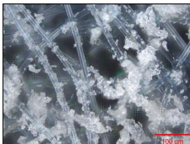
Obr. 45 Snímek třísek vytvořených během šestého cyklu obrábění (20x zvětšeno).
