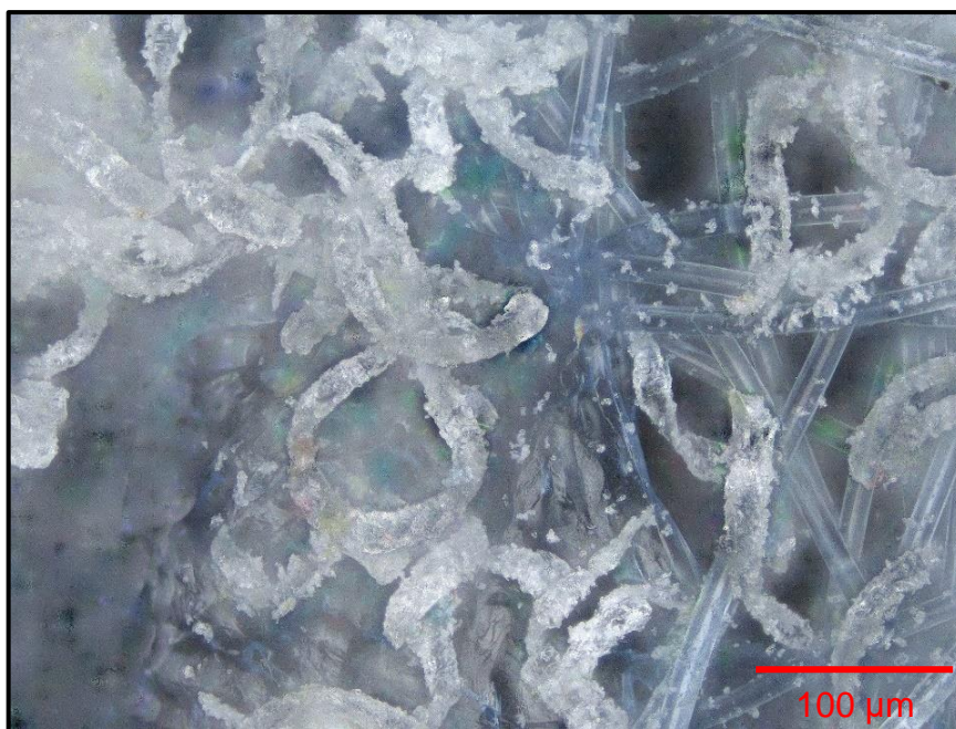
Obr. 38 Snímek třísek po 5 min. frézování vzorku č. 2 (20x zvětšeno).
