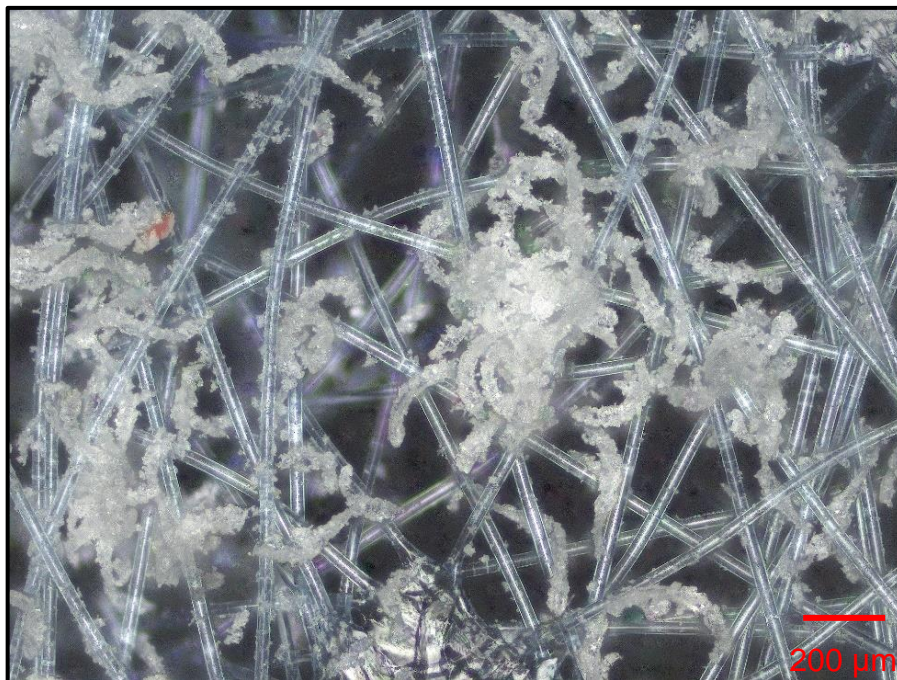
Obr. 31 Snímek třísek po 5 min. obrábění vzorku č. 1 (5x přiblíženo).
