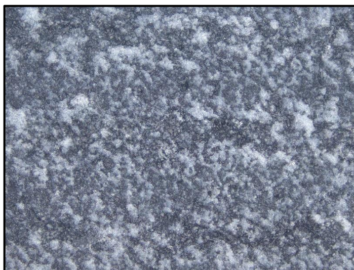
Obr. 63 Povrch vzorku č. 4 po posledním cyklu obrábění.
