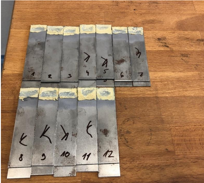
Obrázek 21 Vzorky tmelu ovlivněné klimatickou komorou po zkoušce dle ČSN EN 1465 [vlastní]
