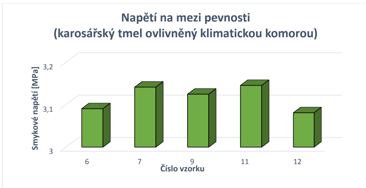
Obrázek 22 Graf smykového napětí na mezi pevnosti u vzorků 1 až 12 ovlivněných klim. komorou [vlastní, příloha číslo 5]
