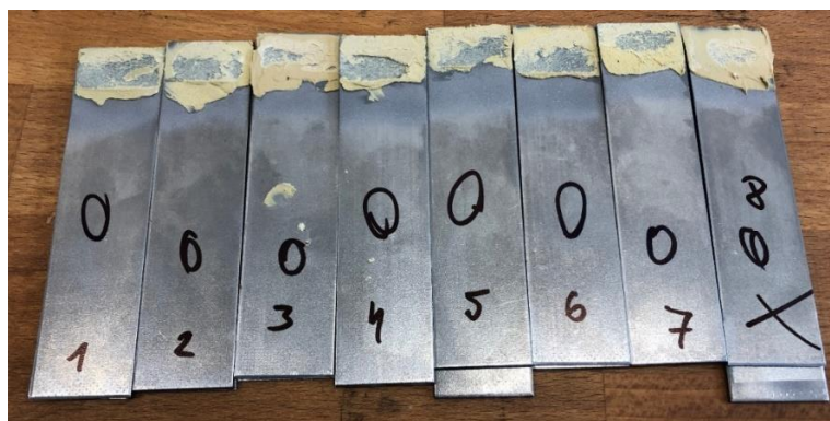
Obrázek 18 Vzorky tmelu neovlivněné klimatickou komorou po zkoušce dle ČSN EN 1465 [vlastní]
