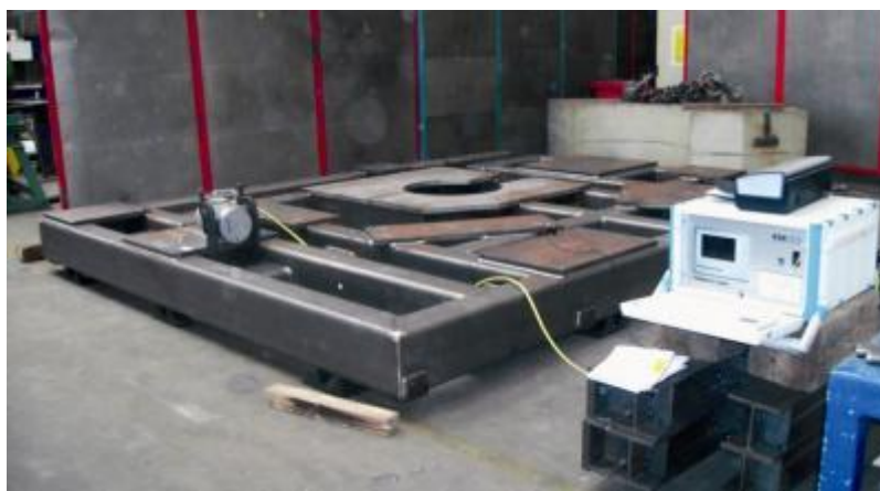
Obrázek 27 Vibmatic 6000 vpravo ovládací jednotka, vlevo pak excentr umístěný na svařenci [12]
