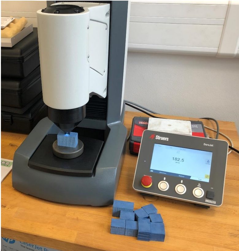
Obrázek 25 Měření tvrdosti HB 5/961 na přístroji DuraJet G5 [vlastní]
