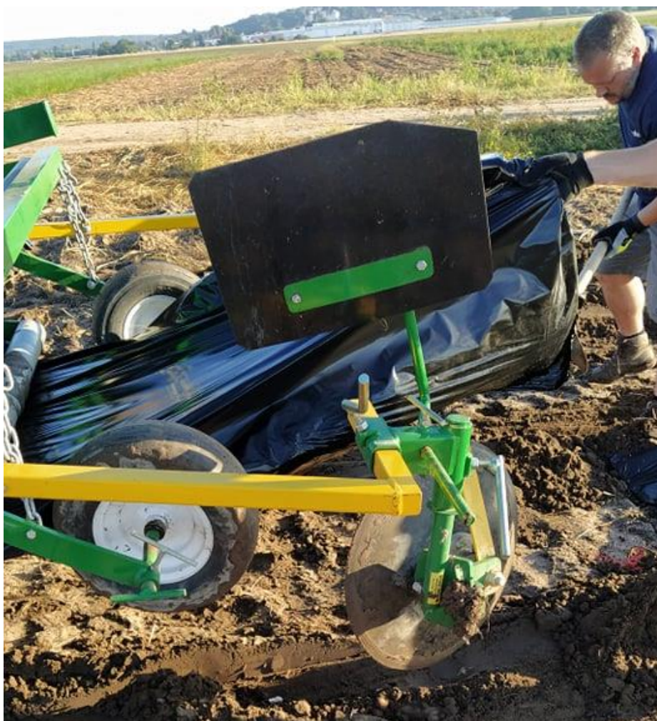
Obrázek 27: Příprava folie, počáteční manuální přehnutí zeminou
