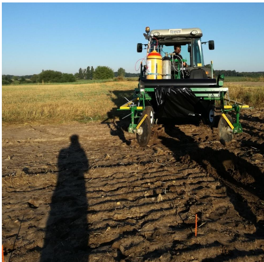
Obrázek 24 Mulčovač s válcem TIF folie
