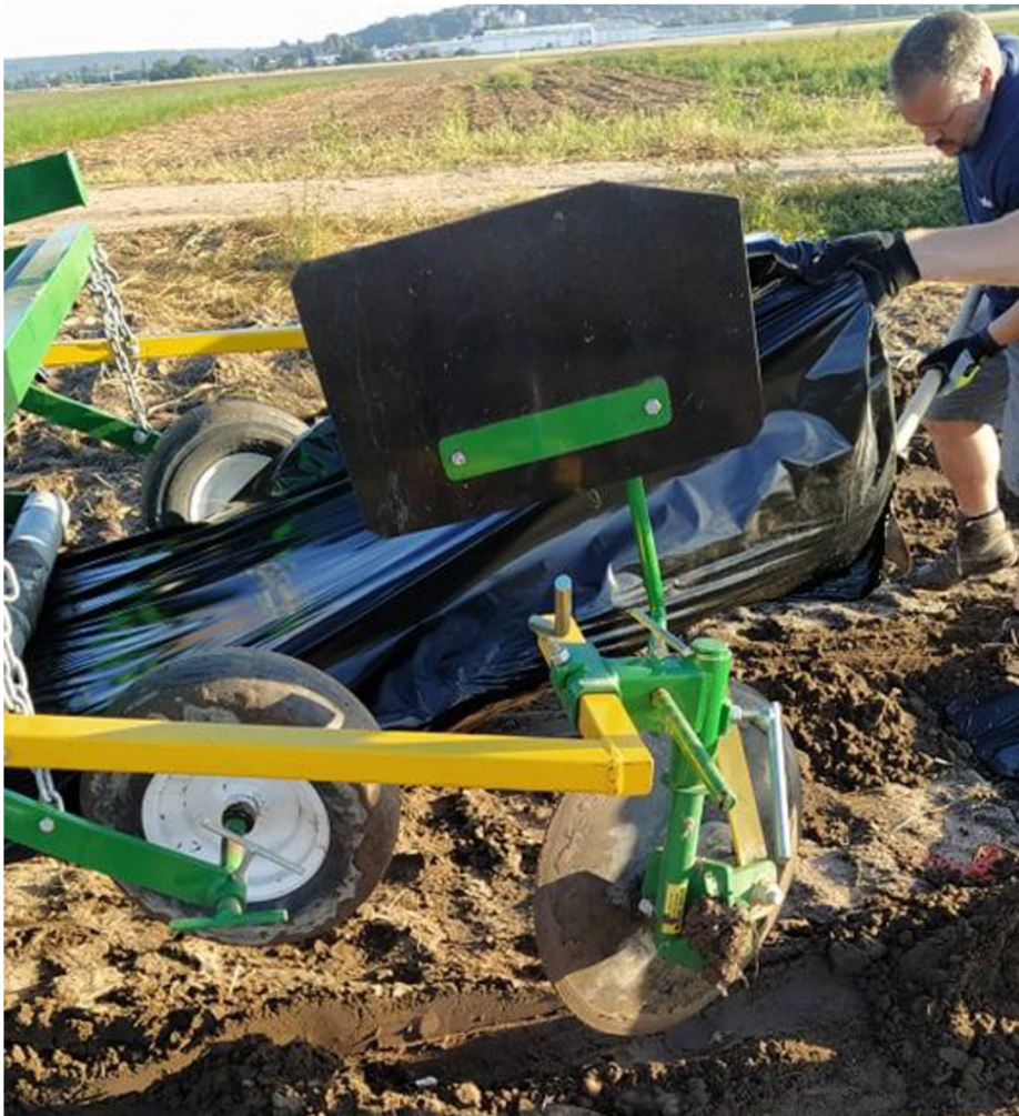
Obrázek 27: Příprava folie, počáteční manuální přehnutí zeminou
