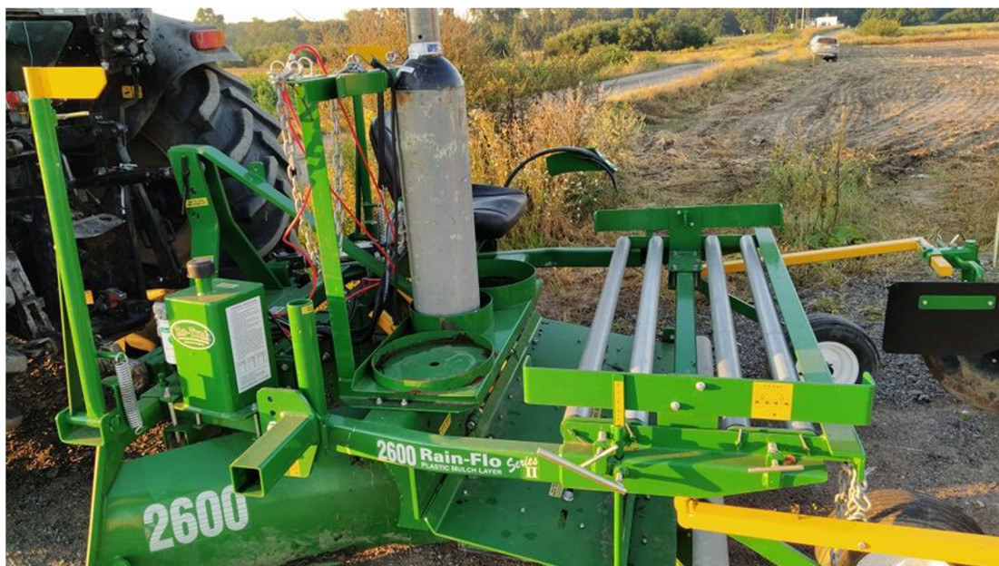
Obrázek 21: mulčovač Rain-flo 2600 s tlakovou lahví s plynem pro pohon válců
