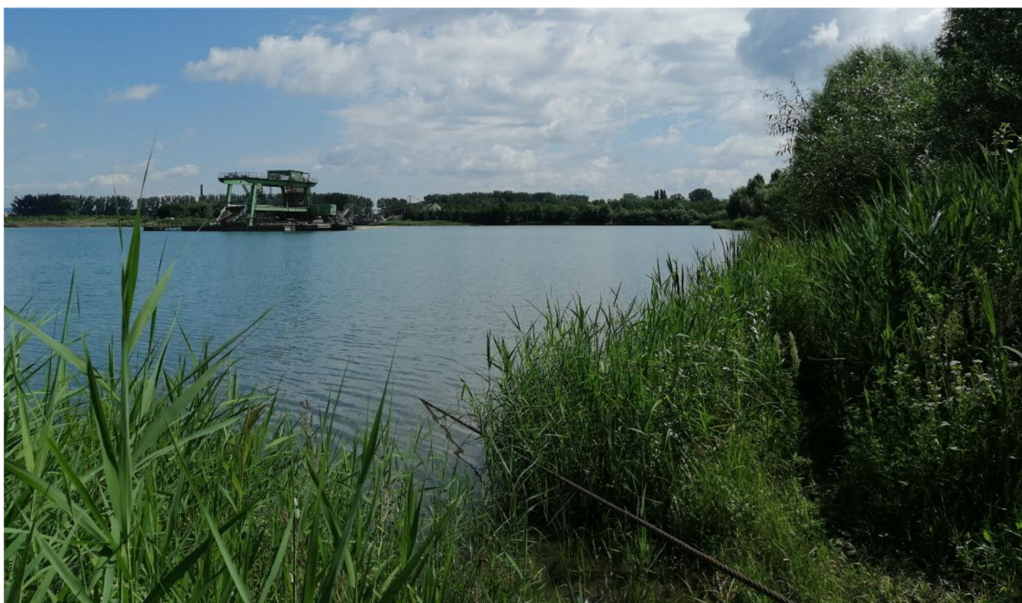
Obr. 1. 12 – Těžební přístroj na pontonu kotvený ocelovým lanem k břehu [6]
