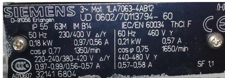
Obrázek 6.3 Výrobní štítek motoru
