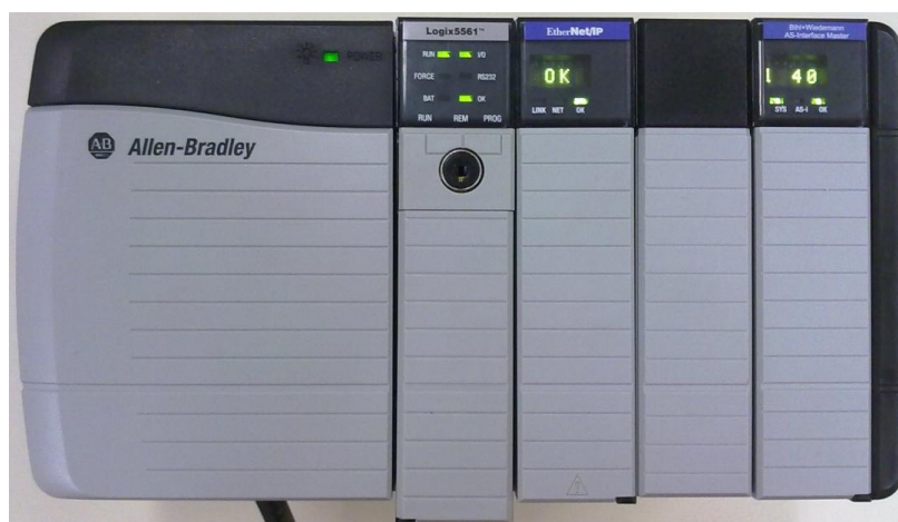
Obrázek 3.2 PLC Allen Bradley ControlLogix 5561 TM
