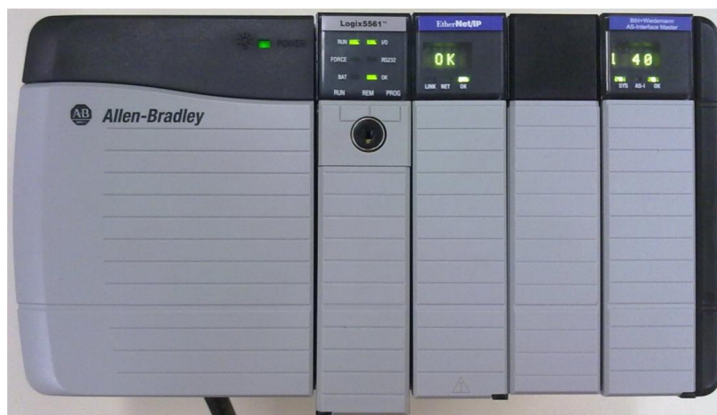
Obrázek 3.2 PLC Allen Bradley ControlLogix 5561 TM
