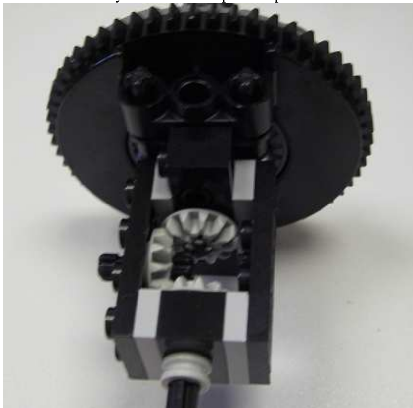
Obr. 2: Sestavený diferenciál bez použití speciální LEGO klece
