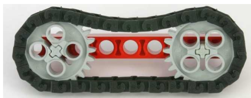
Obr. 10: Převod ozubených kol s řetězem
