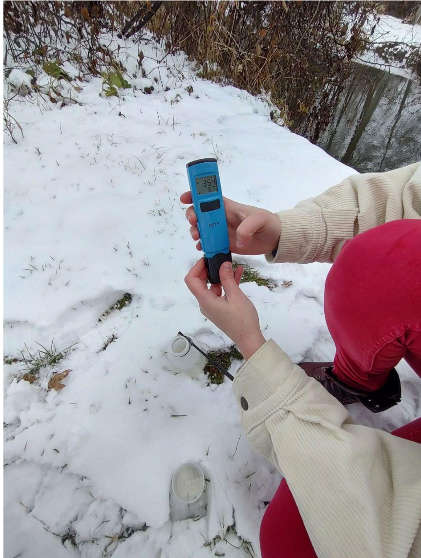
Obr. 13. Konduktometr Dist 3 firmy HANNA (archiv autorky)
