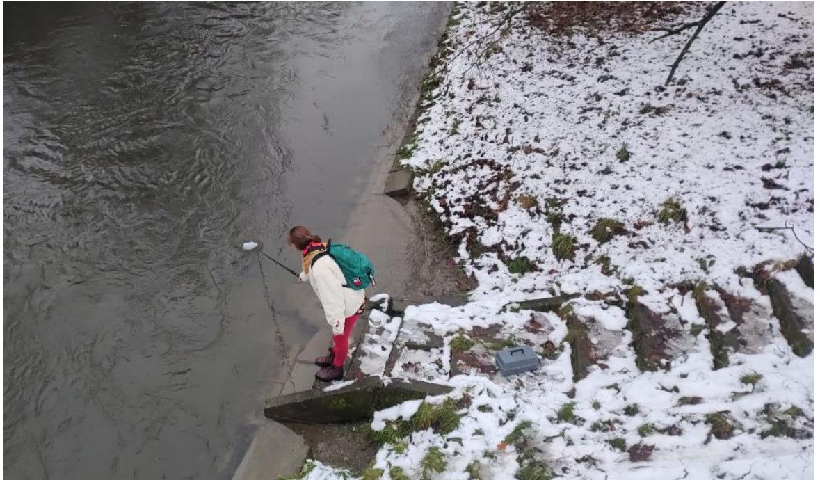
Obr. 12. Odběr vzorku vody pomocí vzorkovače (archiv autorky)
