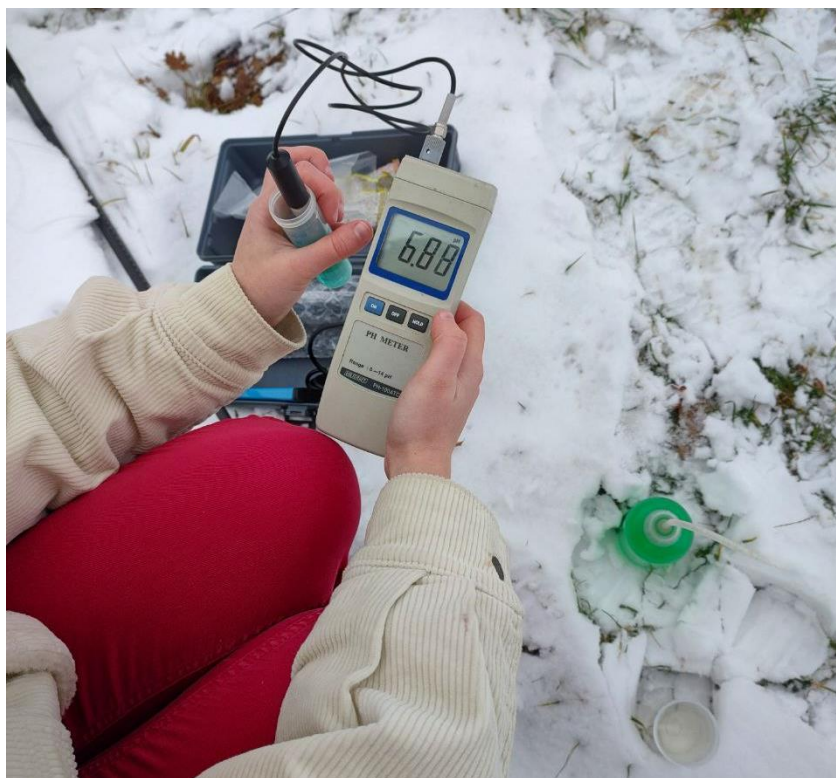
Obr. 15. Kalibrace pH-metru (model aph-100 ATC od firmy Voltcraft) (archiv autorky)
