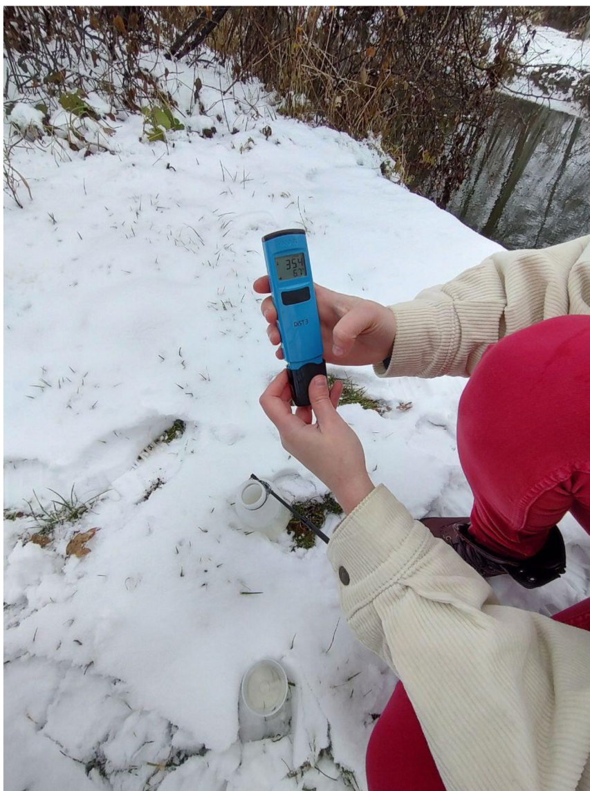
Obr. 13. Konduktometr Dist 3 firmy HANNA (archiv autorky)
