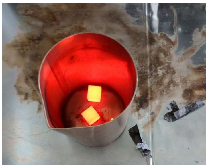
Obr. 3.4: Chladnutí vzorků po tepelném zpracování.
