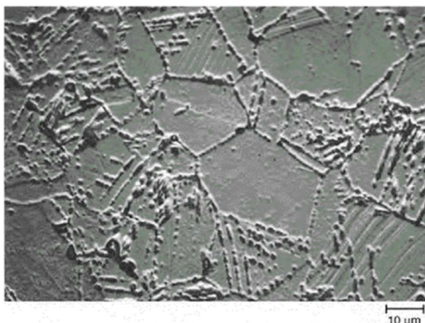
Obr. 2.14: Austenitická zrna s karbidy chromu na hranicích zrn. Ocel AISI 304, SEM. [10]
