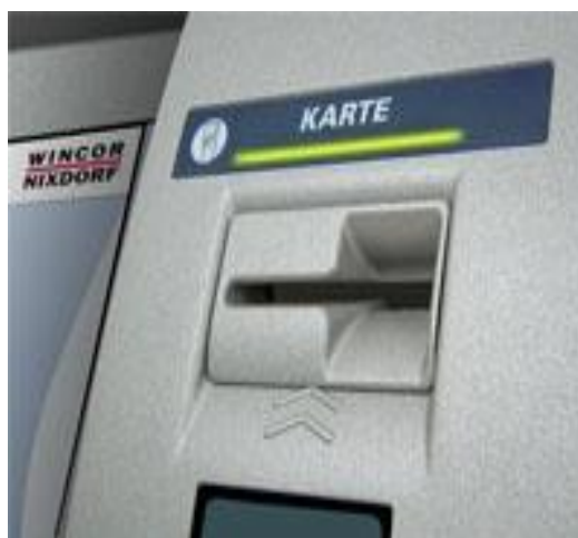
Obr. č. 34 Bankomat osazen antiskimmovacím zařízením
