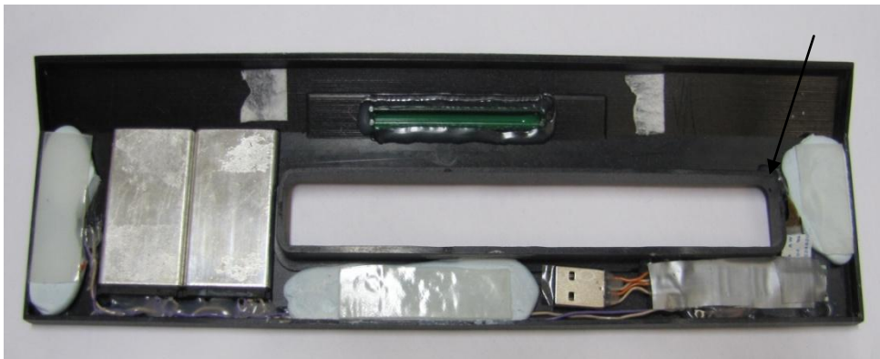
Obr. č. 30 Bankomat osazen kamerou v prostoru výběru hotovosti
