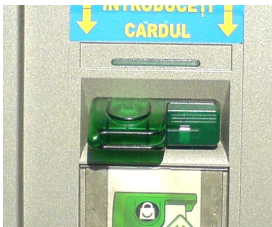
Obr. č. 31,32 Nástavec protiskimmovacího zařízení tzv. „zelený zobák“
