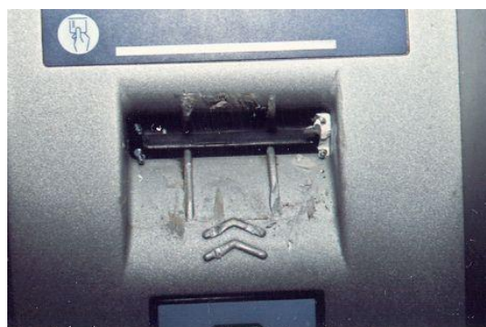
Obr.č.25,26 Bankomat osazen skimmovacím zařízením
