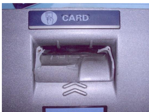
Obr.č.25,26 Bankomat osazen skimmovacím zařízením
