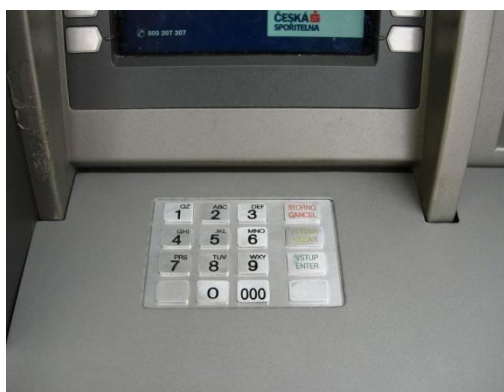
Obr. č. 27 Bankomat osazen PinPadem
