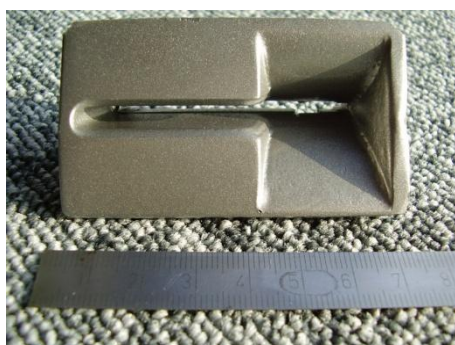
Obr. č. 22 Přední strana skimmovacího zařízení
