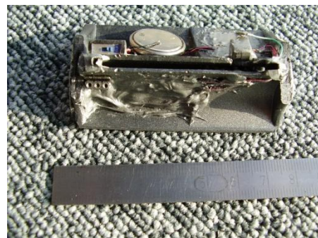
Obr. č. 23 Zadní strana skimmovacího zařízení
