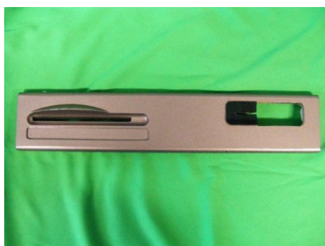
Obr. č. 20 Přední strana skimmovacího zařízení
