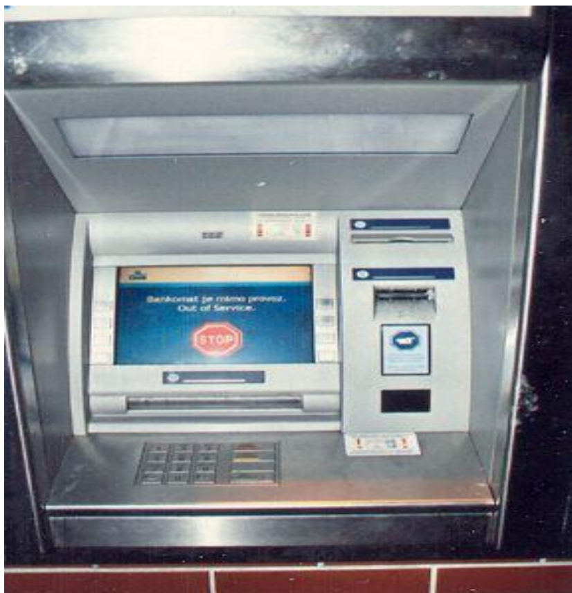
Obr. č. 24 Bankomat osazen skimmovacím zařízením
