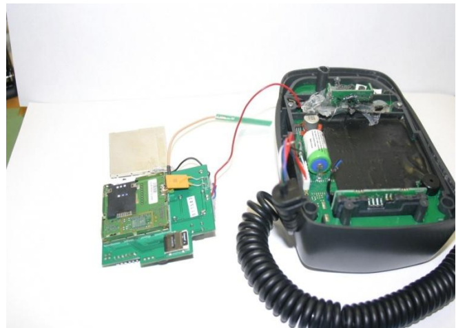
Obr. č. 17 Terminál s upraveným PinPadem
