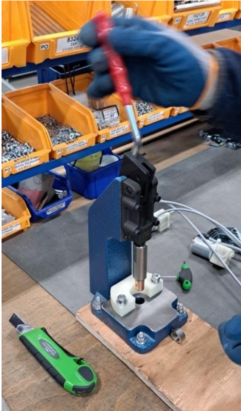
Obrázek č. 11 - ruční vyvrtávání otvorů Zdroj: vlastní
