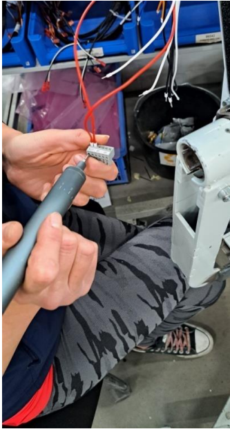
Obrázek č. 9 – zobrazení práce s ručním šroubovákem Zdroj: vlastní
