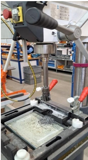
Obrázek č. 10 - sloupová vrtačka pro vystružování děr do krytů Zdroj: vlastní
