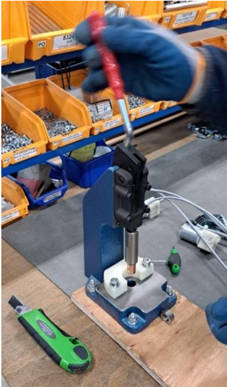
Obrázek č. 11 - ruční vyvrtávání otvorů Zdroj: vlastní
