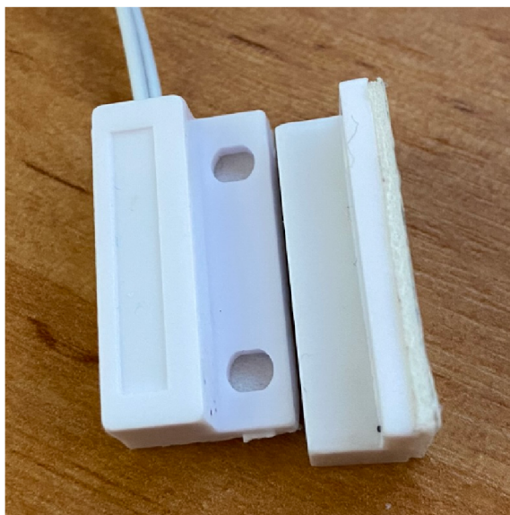
Obrázek 2.4: Magnetická závora. Vlevo je část připojená k mikrokontroleru, vpravo je část umístěná na dveře/okno. Logická hodnota se změní, jakmile se části dostatečně přiblíží k sobě.
