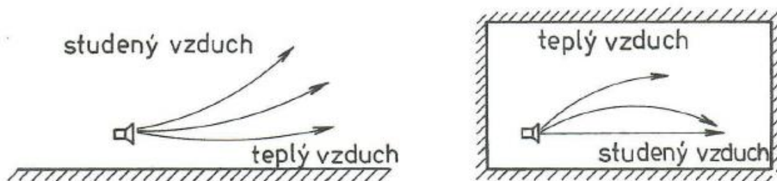
Obr. 2.5 Lom zvukového paprsku vlivem různých teplotních vrstev vzduchu [7]
