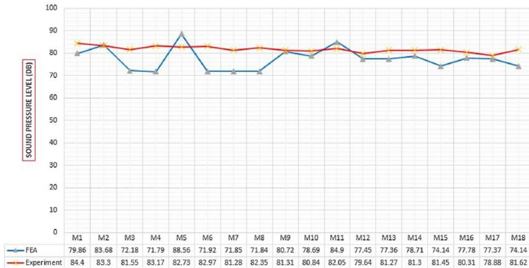
Obr. 6.7 Porovnání experimentálního a numerického přístupu pro zjištění hladiny akustického tlaku uvnitř kabiny nákladního automobilu pro různé materiály a jejich kombinace:
