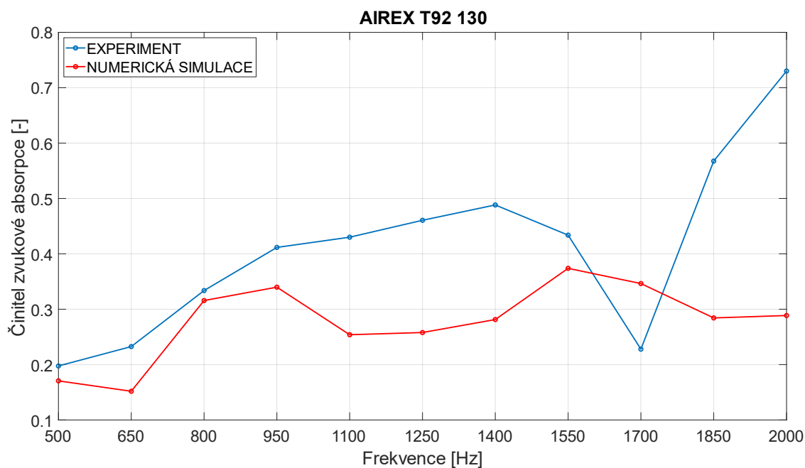
Obr. 7.18 Porovnání výsledků jednotlivých přístupů pro pěnu AIREX T92 130 s průměrováním hodnot zjištěných numerickou simulací v oblasti \pm 5 mm
