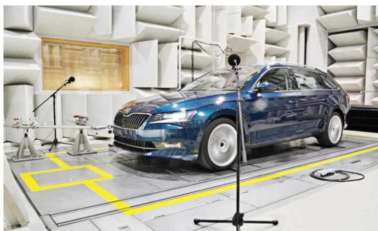
Obr. 1.1 Testování vozidla na válcovém dynamometru uvnitř polobezdozvukové komory [1]
