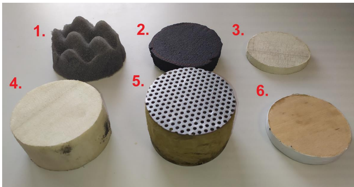
Obr. 7.1 Vzorky zkoumaných akustických materiálů: 1. ROCKFONIK, 2. Kaiflex/Armaflex, 3. AIREX T92 130, 4. AIREX T92 200, 5. WILLBRANDT Contrabel, 6. Překližka
