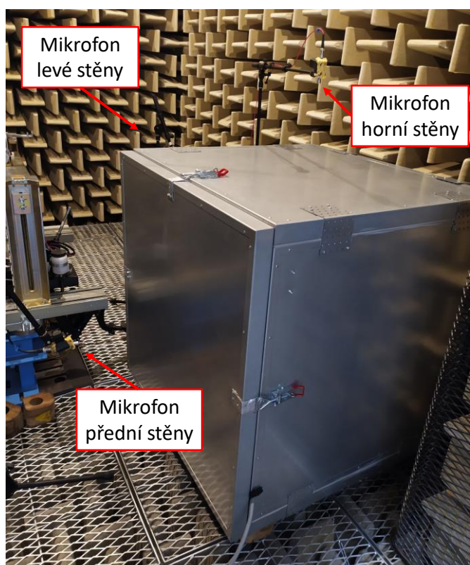
Obr. 8.4 Ustavení mikrofonů před jednotlivé stěny experimentálního zařízení
