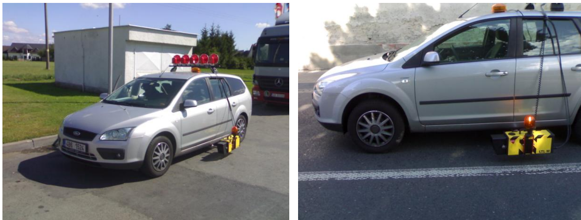
Obr. 19 – Retroreflektometr LTL-M namontovaný na vozidle
