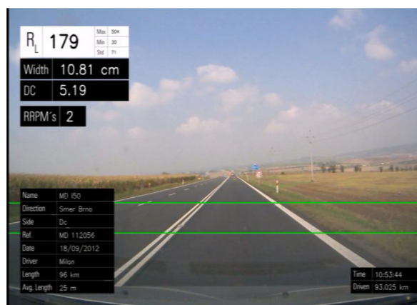
Obr. 44 – Retroreflexe na silnici I/50, DČ, směr Slavkov u Brna, úsek Holubice – Slavkov u Brna
