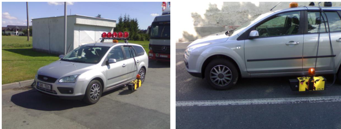
Obr. 19 – Retroreflektometr LTL-M namontovaný na vozidle
