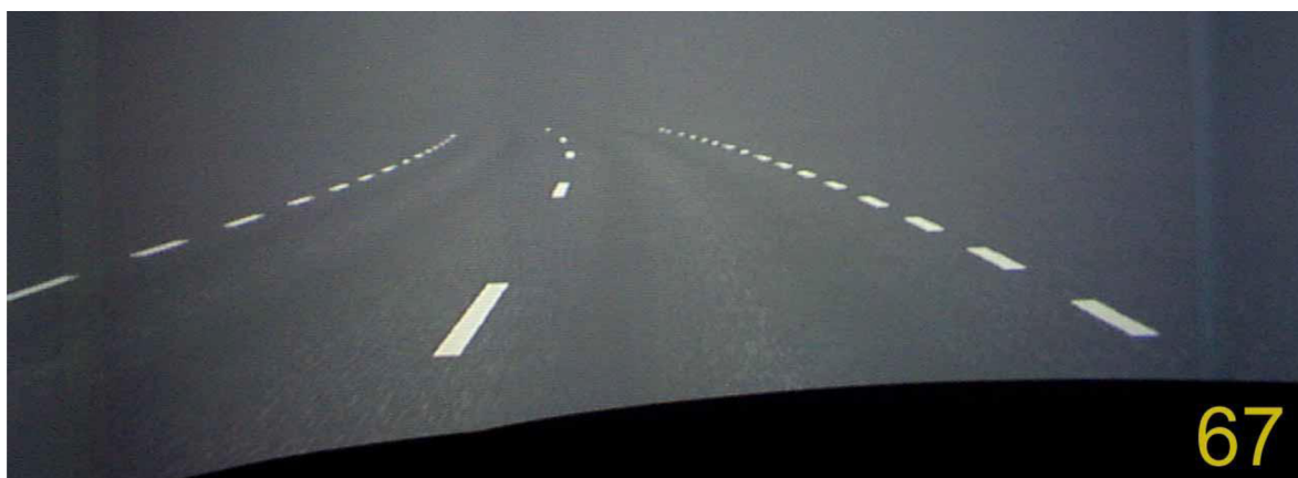
Obr. 6 - Silniční scéna, čísla v pravém rohu udávají dohlednost v metrech
