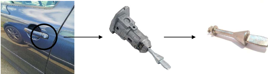
Obr. 38 Znáznornění použití vyráběné součásti (pádl)
