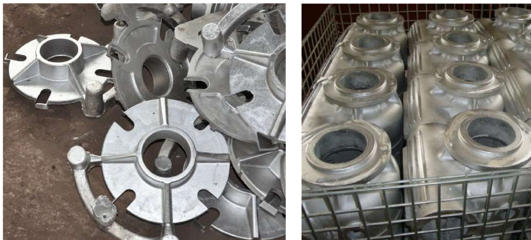
Obr. 35 Příklad odlitku technologií lití do pískových forem [18]
