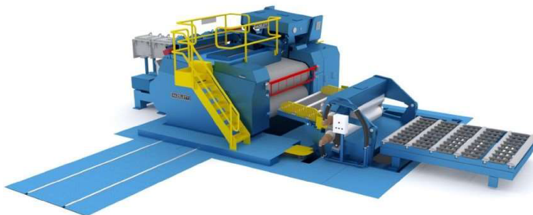
Obr. 9 Stroj pro kontinuální lití zinkových slitin [16]
