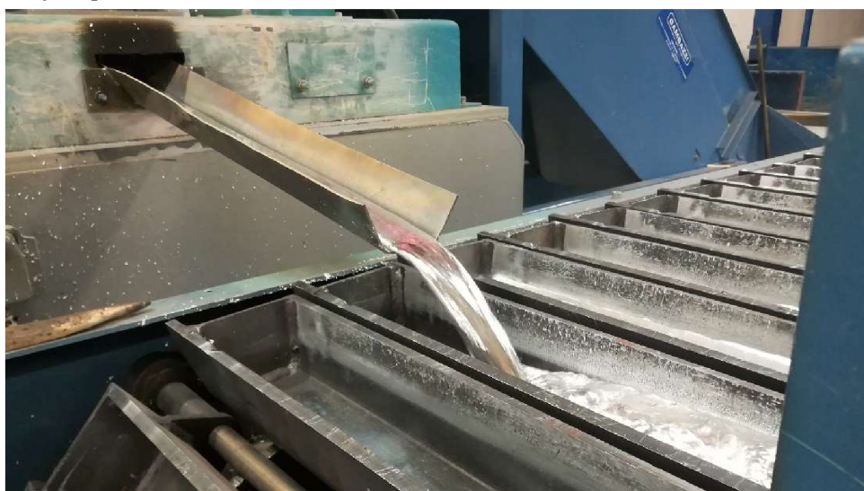
Obr. 10 Odlévání ingotů ze slitiny zinku
