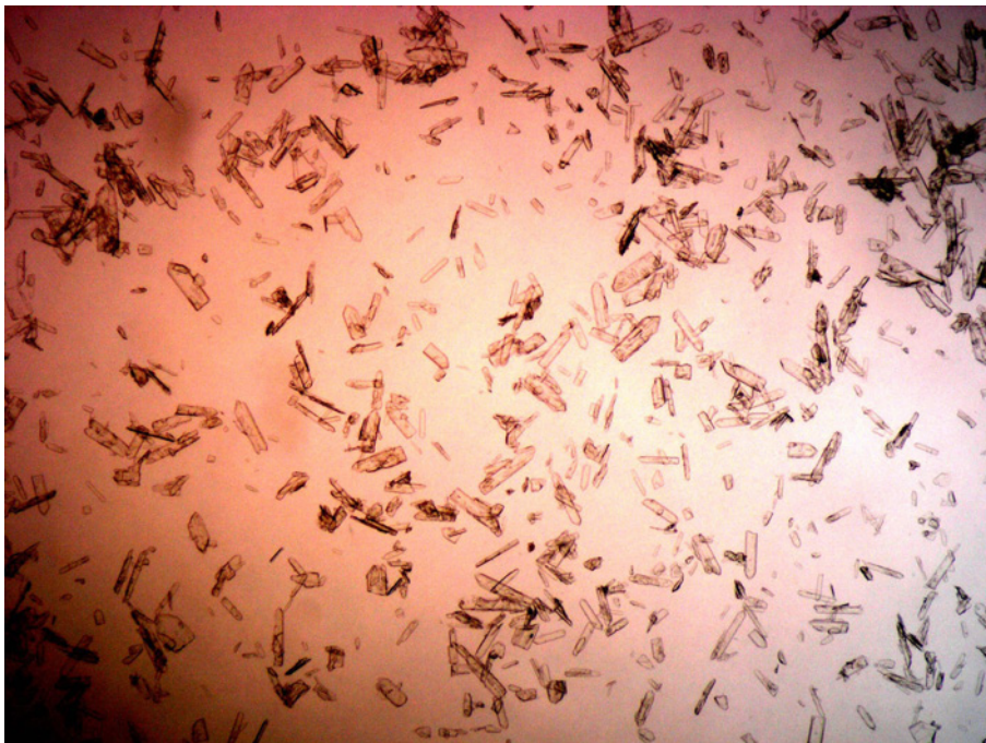
Obr. č. 57: 40 x zvětšeno, průměrná velikost krystalů 95,44 \mu\text{m} .
