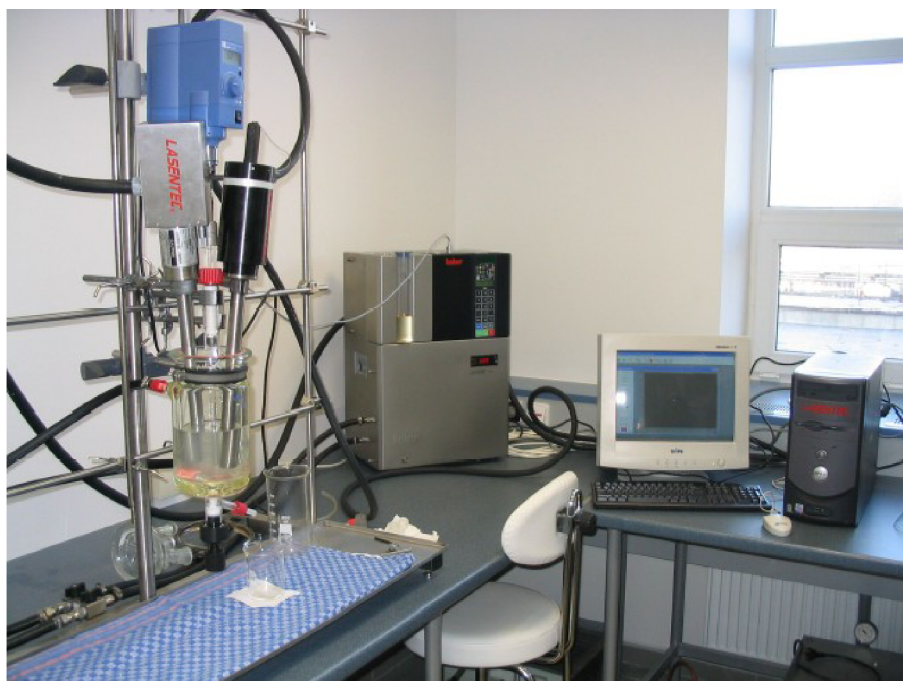
Obr. č. 24: Systém pro měření velikosti a počtu částic Lasentec FBRM M 400 L, Mettler-Toledo, Inc.
