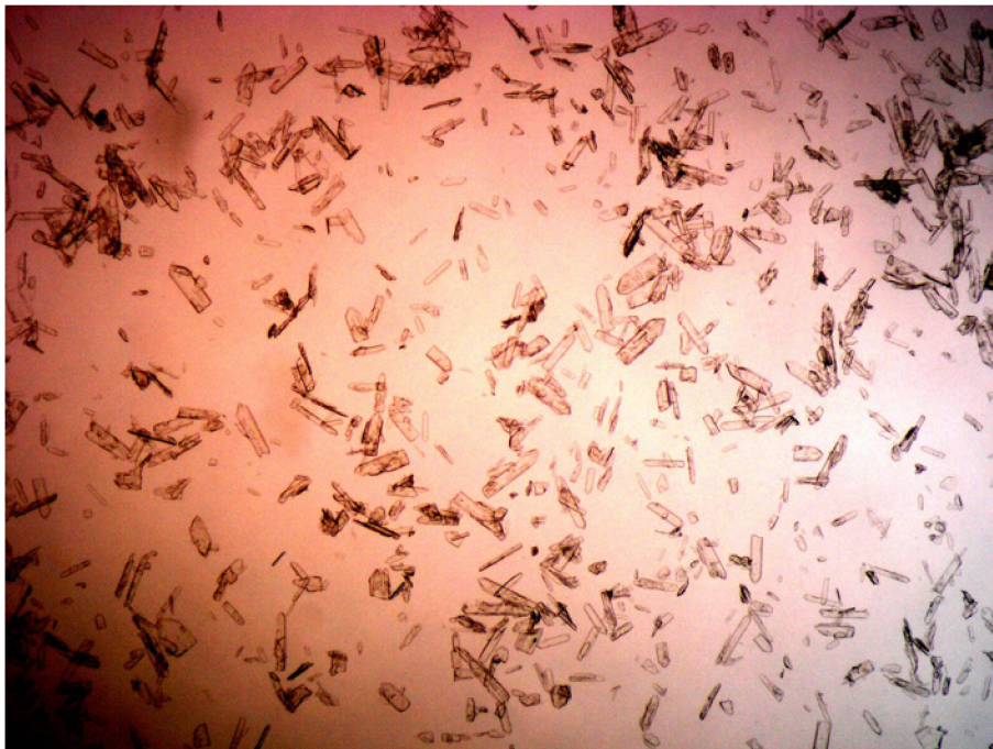
Obr. č. 57: 40 x zvětšeno, průměrná velikost krystalů 95,44 μm.
