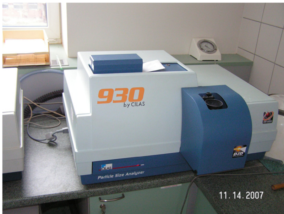
Obr. č. 27: Laserový analyzátor distribuční velikosti částic CILAS 930.
