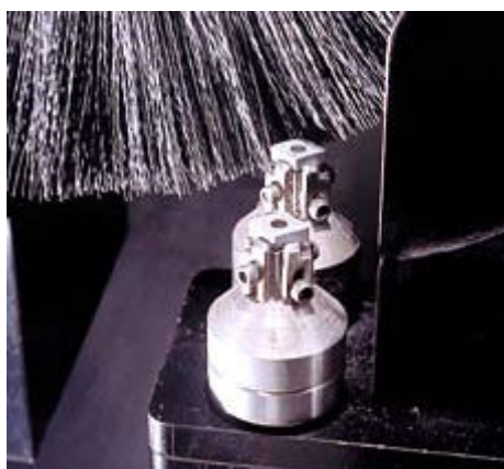
Obr. 1.18 Kartáčování nástrojů ze slinutého karbidu 12
