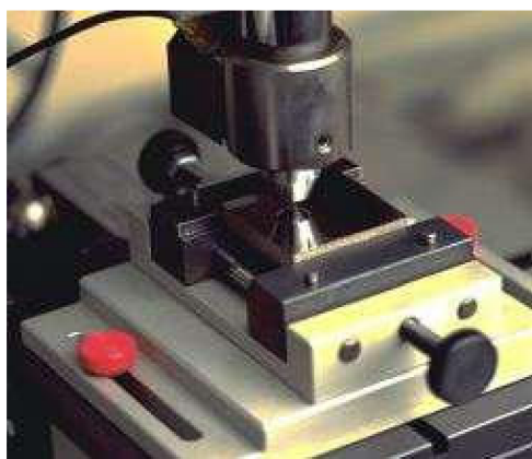
Obr. 1.51 Scratch tester a zařízení pro provádění testů „PIC – on – DISC“ (tribometr) 34
