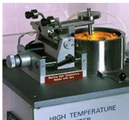
Obr. 1.51 Scratch tester a zařízení pro provádění testů „PIC – on – DISC“ (tribometr) 34
