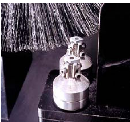
Obr. 1.18 Kartáčování nástrojů ze slinutého karbidu 12
