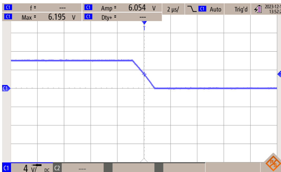
Obr. 32 Detail sestupné hrany na výstupu PWM generátoru, pro vyšší kmitočty.
