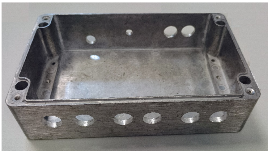
Obr. 52 Konstrukce kovové krabičky.
