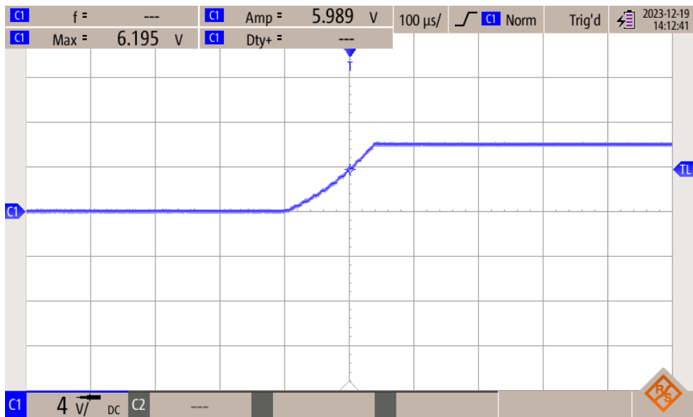
Obr. 29 Detail náběžné hrany na výstupu PWM generátoru, pro nízké kmitočty.
