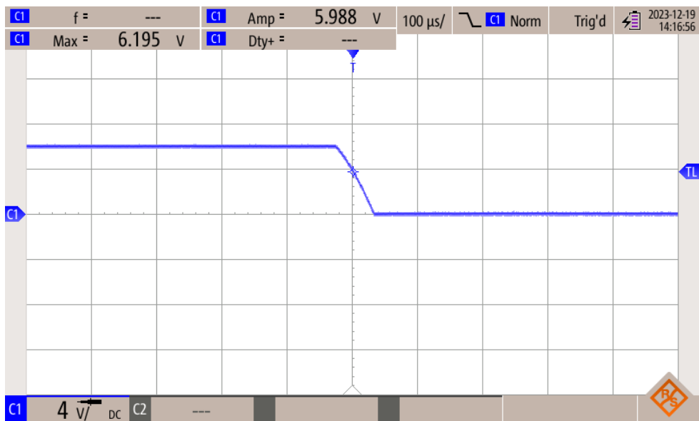
Obr. 30 Detail sestupné hrany na výstupu PWM generátoru, pro nízké kmitočty.
