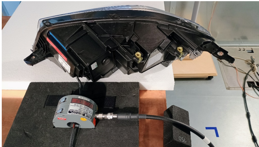
Obr. 67 BCI – substituční metoda. Detail na průchod kabelového svazku BCI injektážní sondou.
