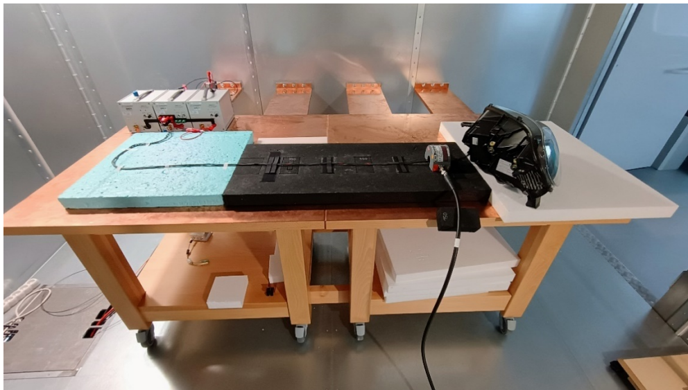
Obr. 65 Zapojení metody BCI – substituční metoda.
