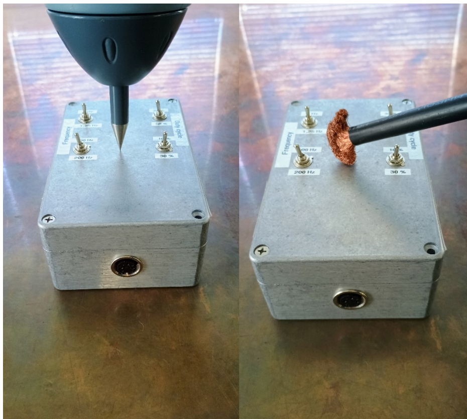
Obr. 130 Detail na aplikaci výboje a vybíjení krytu Load simulátoru
