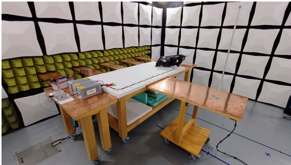
Obr. 101 Zapojení pro měření RE s monopólovou anténou. Měření výstupu Load simulátoru pro směrové světlo.
