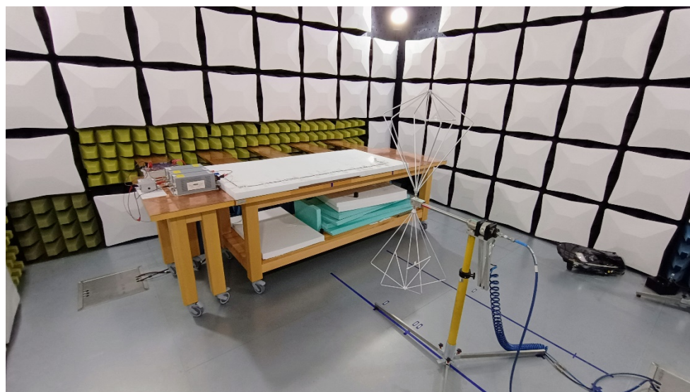
Obr. 108 Zapojení pro měření RE s bikonickou anténou. Měření výstupu Load simulátoru pro poziční světlo.
