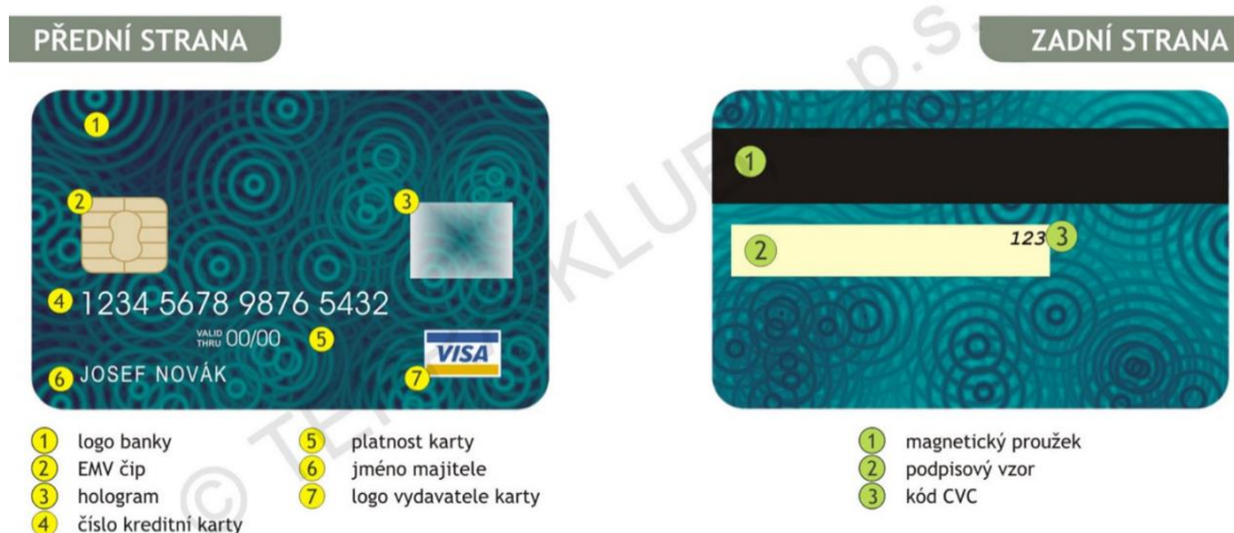
Obrázek 1 - Bezpečnostní prvky platebních karet Zdroj: www.dnesni-svet.cz
