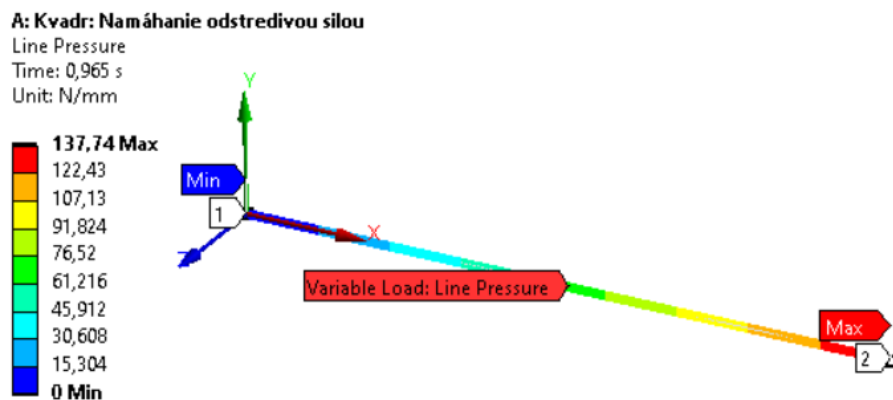
Obr. 15: Okrajové podmienky v programe Ansys pre zaťaženie odstredivou silou
