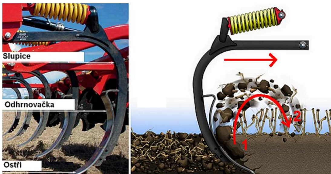
Obr. 4.4 Popis pracovního orgánu a znázornění cirkulačního pohybu půdy[31]
