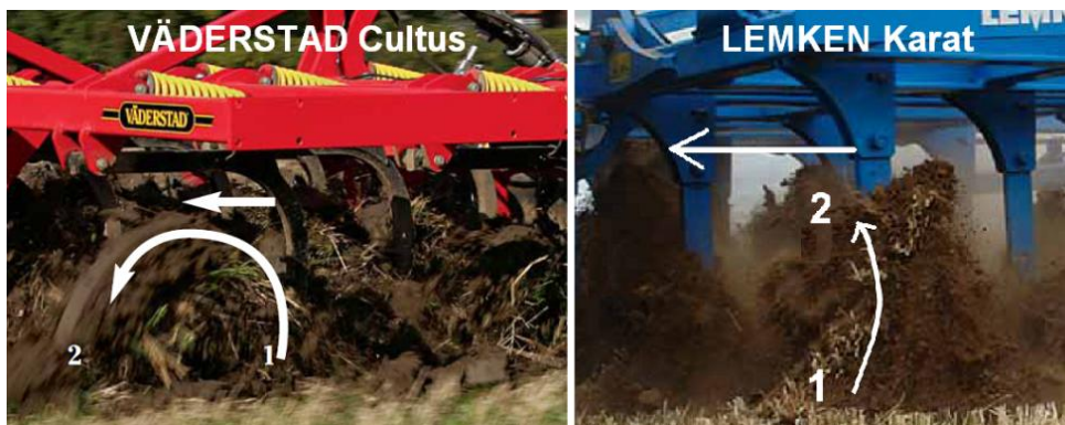
Obr. 4.9 Znárodnění toku zeminy u porovnávaných kypřičů [31, 32]
