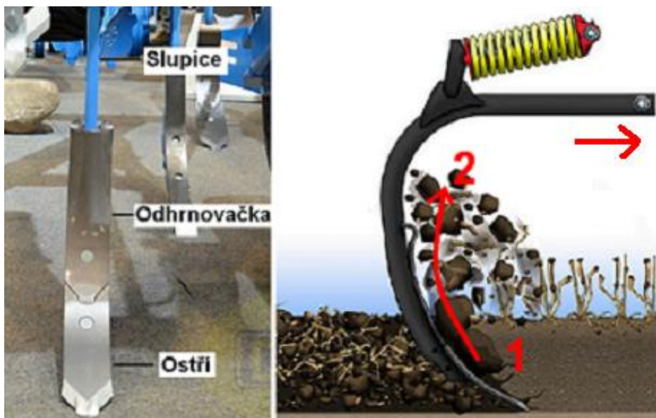
Obr. 4.7 Popis pracovního orgánu a znázornění odlišného pohybu půdy oproti cirkulačnímu [31, 32]
