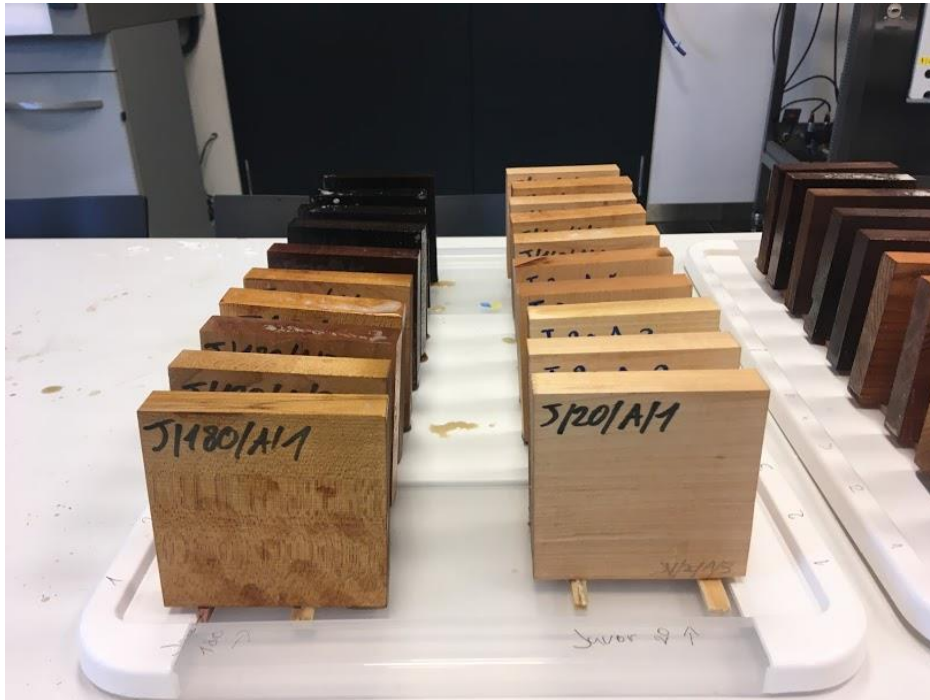
Obr. 11 Vysušování naneseného retardéru na zkušebních vzorcích
