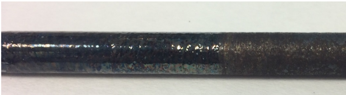
Obrázek 13: Snímek elektrody číslo 2 po testování životností
