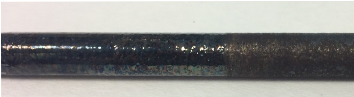
Obrázek 13: Snímek elektrody číslo 2 po testování životností
