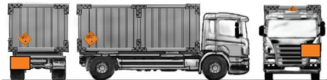
Obrázek 9: Označení vozidla výstražnými tabulkami. Zdroj: Pazdera, 2016
