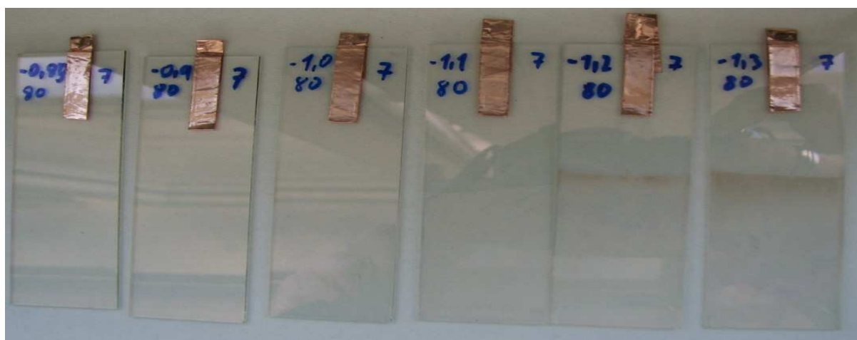
Obr. 15. Aktivní vrstvy, poslední dvě skla z pravé strany pro -1,2 a -1,3 V u ITO 80\Omega\text{ (cm}^{-2}\text{)}
