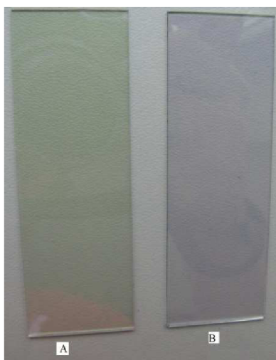
Obr. 18. Skleněný substrát 'A' s tenkou vodivou vrstvou ITO ( \text{In}_2\text{O}_3:\text{Sn} ) a skleněný substrát 'B' s tenkou vodivou vrstvou ITO s vakuově naprášenou tenkou funkční vrstvou \text{TiO}_2 .
